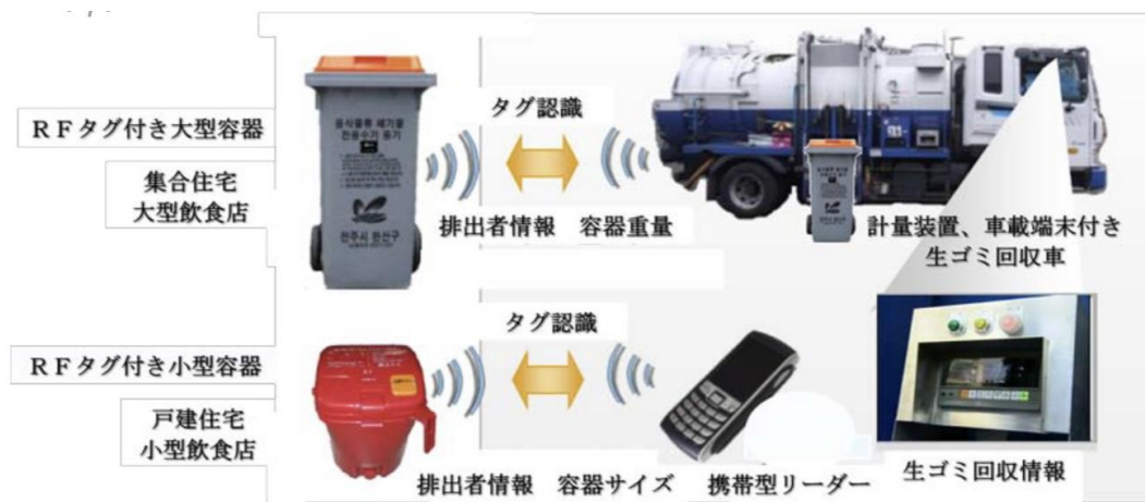
図10 韓国のRFIDによる生ごみの計量、回収方式(排出量別)
